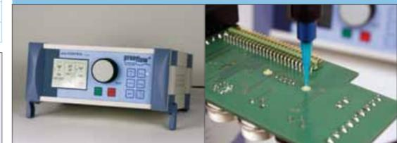
eco-CONTROL EC 200-B preeflow®, unidad integrada Sistema integrado flexible para armarios de acero existentes
