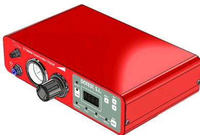
**Características:** El controlador universal DTS 8000 es un dispositivo utilizado para la regulación de dosificaciones de productos monocomponentes de manera precisa y segura. La lectura de la presión se consigue mediante un manómetro analógico que muestra valores de 0 a 7 BAR. También cuenta con tres modos de trabajo (Manual, Auto y Ciclo) y un control de vacío para prevenir el goteo.
