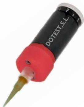
**Características:** La válvula de diafragma VD510 permite pilotar tanto adhesivos de cianoacrilatos como anaeróbicos. Posee un tornillo de ajuste de la carrera de la membrana que permite regular el caudal del producto. Las partes del control de material y pilotaje neumático están completamente separados.
